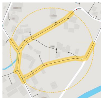
漏水可能性エリアのアプリ表示例
