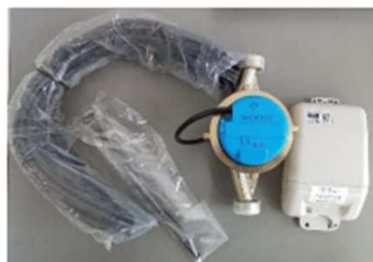
水道メーター・通信機器
