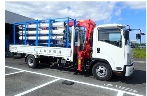
水資源機構が所有する 可搬式浄水施設
