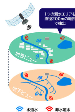
人工衛星を用いた漏水検知手法
