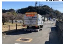
(空洞探査車による調査)
