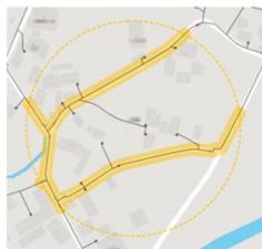
漏水可能性エリア表示例
