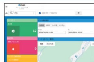
クラウド上に収集したデータから漏水検出の状況を可視化
