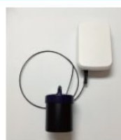
仕切弁に設置する振動センサーと通信装置
