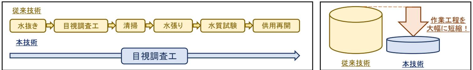
本技術の水質に影響を与えない調査方法によって水抜き・清掃・水張り・水質試験が不要となります。従来技術の作業工程を大幅に短縮、施設の供用を停めることなく調査ができるため、**効率化と低コスト化**が実現します。
