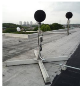
騒音測定局 (屋上設置時)
