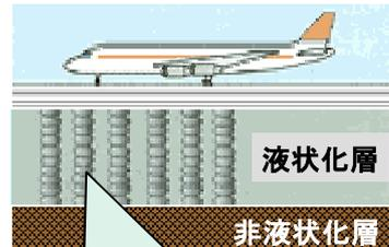
液状化層の地盤改良対策により、舗装の損壊を防止
