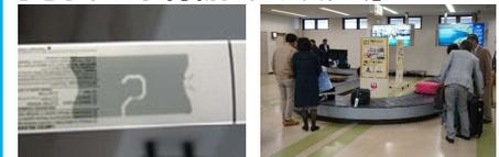
旅客手荷物に付けた電子タグを専用装置で読み取ることにより、旅客手荷物のトラッキングを実現し、到着便の搭降載状況や受け渡し時間の目安を旅客にリアルタイムで通知し、待ち時間を有効活用。
