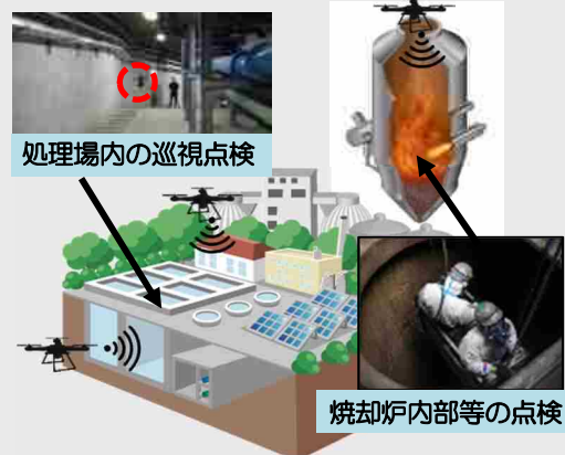
ドローンによる処理場内の点検
