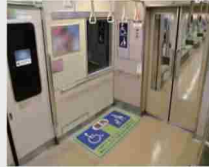
鉄道車両内のフリースペース (公共交通機関の移動等円滑化ガイドラインより)
