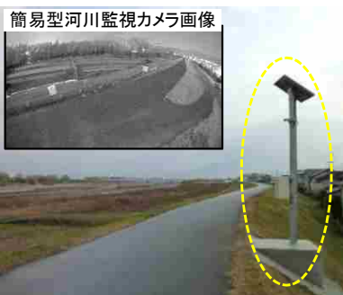
簡易型河川監視カメラ
