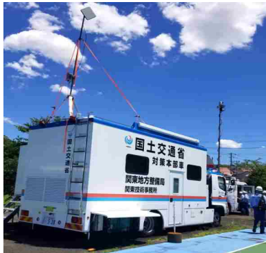
災害対策本部車へ可搬型長距離対向通信システム(i-RAS)を設営 【R元.7 関東地整防災通信訓練】
