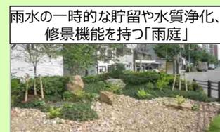
雨水の一時的な貯留や水質浄化、
