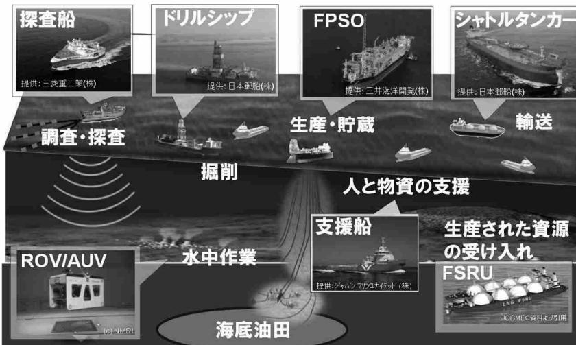
FPSO: 浮体式石油生産貯蔵積出設備 ROV/AUV: 遠隔操作型無人潜水機/自律型無人潜水機
