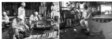
ぎょう鉄(鉄板曲げ加工)
