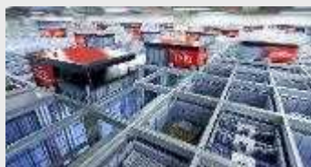
自動倉庫型ピッキングシステム
