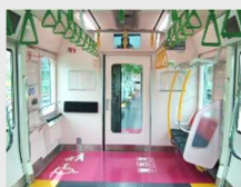
鉄道車両内のフリースペース (公共交通機関の移動等円滑化 ガイドラインより)
