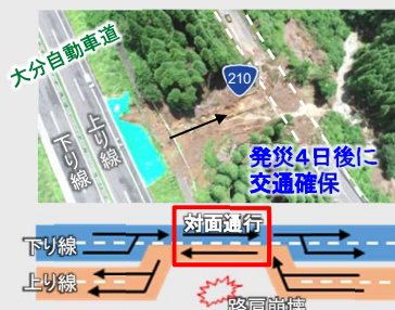
【大分自動車道 九重IC～湯布院IC】 九重IC～湯布院IC間の上り線で路肩崩壊が発生し、並行する国道210号も同時に被災。一時交通が寸断されたものの、大分自動車道の下り線を対面通行として活用することで、発災4日後に広域交通を確保
