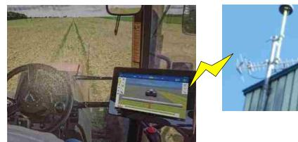
農地の大区画化と併せて、町がRTK-GNSS基地局を設置し、農業機械の位置情報の精度を大幅に改善。
