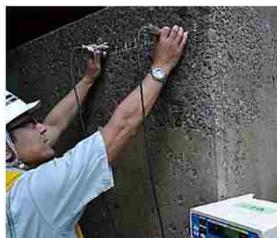
非破壊試験(表面走査法)
