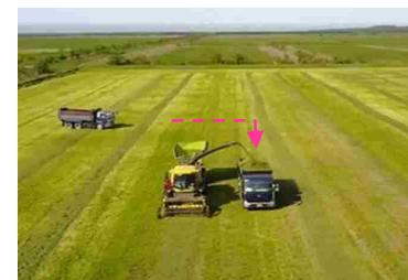
排水改良により地耐力が高まり収穫機とダンプの併走が可能に(収穫と積込みを同時にを行うことで運搬速度がアップ)。
