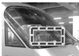
営業列車等の運転台に VRカメラを搭載
