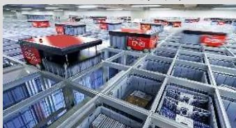
自動倉庫型ピッキングシステム
