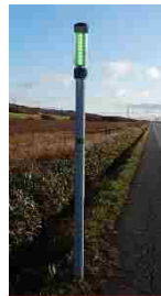
太陽光発電による 自発光式スノーポール
