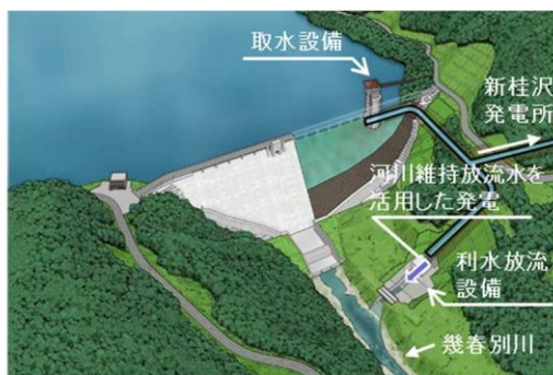
河川維持放流水を活用した小水力発電の例 (新桂沢ダム (三笠市))
