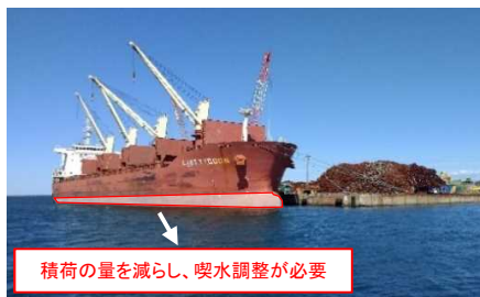
積荷の量を減らし、喫水調整が必要 約30,000DWT船 →現状は水深の制約により満載で入港できない
