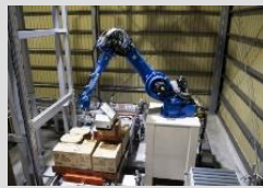
ピッキングロボット
