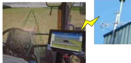
農地の大区画化と併せて、町がRTK-GNSS※基地局を設置し、農業機械の位置情報の精度を大幅に改善。写真提供：今金町
