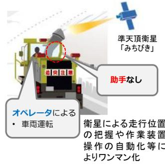
吹雪時の車両運転支援により除雪作業の継続が可能となり、天候回復後速やかに通行を再開
