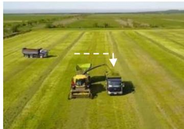
排水改良により地耐力が高まり収穫機とダンプの併走が可能に(収穫と積込みを同時に行うことで運搬速度がアップ)。
