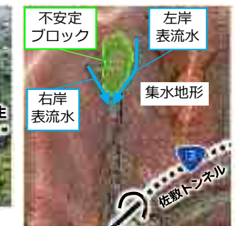
高度化された点検手法の例 レーザープロファイラ調査
