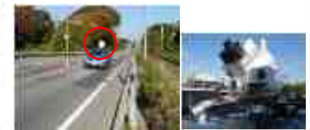
車載装置による路面性状測定
