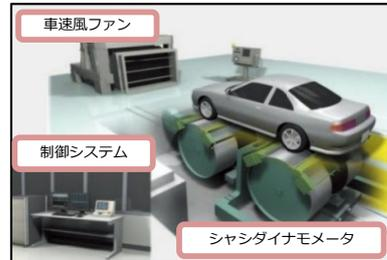
屋内での同一の条件下での試験実施が可能である、シャシダイナモメータによる評価手法となるよう国際調和試験法 (WLTC) を日本が主導して制定。
