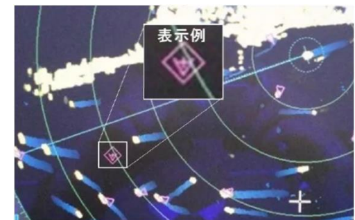
船舶用レーダー画面(AIS航路標識の表示例)
