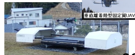
▲ドローンによる自動監視を可能とするドローンポート
