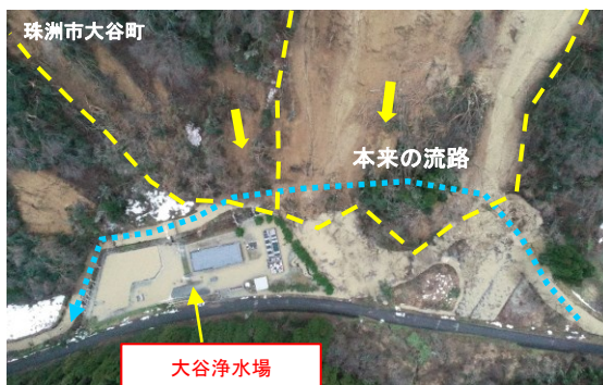
浄水場を機能停止にした河道閉塞
