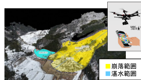
▲ドローン空撮画像から作成した3次元モデル
