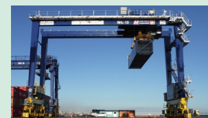
我が国の脱炭素化技術を活用した港湾のFC荷役機械
