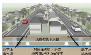
対策工事のイメージ
