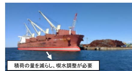
約30,000DWT船 →現状は水深の制約により満載で入港できない
