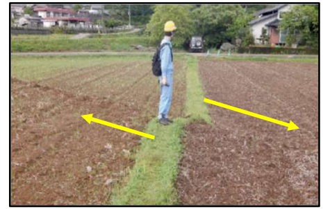
右横ずれした地震断層 (平成28年(2016年)熊本地震)
