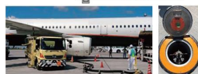
【新千歳空港】ハイドラント共用開始による給油作業の効率化(令和4年12月～)
