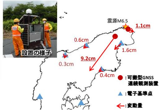
可搬型GNSS連続観測装置が捉えた地殻変動（令和5年5月石川県能登地方の地震）
