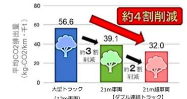
ダブル連結トラックによるCO<sub>2</sub>削減効果 (千トン・km当たりの排出量)
