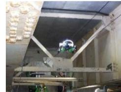
桁間に設置したロープ上に装置が移動しながら損傷把握
