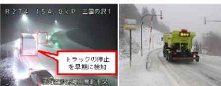
AI画像解析技術を用いた交通障害検知
