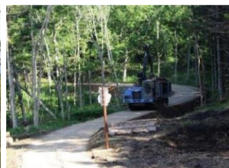
玉切りした木材を運ぶ高性能林業 機械「フォワーダ」
