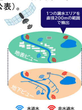
人工衛星を用いた漏水検知手法
