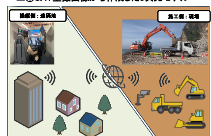
▲③遠隔地から重機を操作し安全性向上や省人化対策(イメージ)
