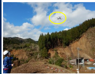
②UAVを用いた土砂災害箇所の調査
