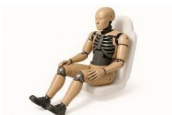
＜衝突時乗員保護性能試験THOR※ダミー導入＞
