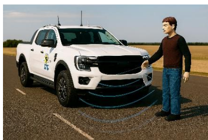
歩行者対応衝突被害軽減 ブレーキの性能評価(イメージ)
