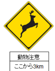
区間を明示した警戒標識
