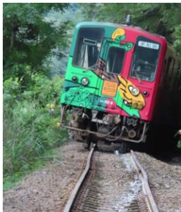
支障物の見逃しによる脱線事例
