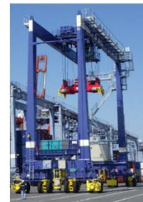
遠隔操作化RTG
