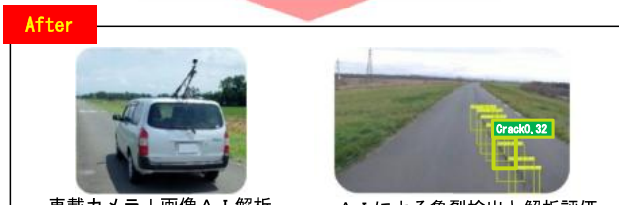
車載カメラ+画像AI解析
