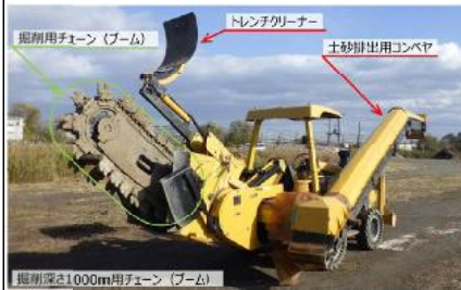
トレンチャー全景
