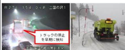
A I 画像解析技術を用いた 交通障害検知
