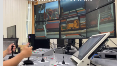
ガントリークレーンの遠隔操作イメージ ※写真は技術開発中のもの
