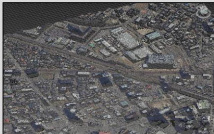
航空レーザ測量による点群データ DEM(数値地形モデル)データ
