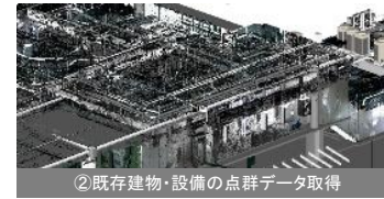
②既存建物・設備の点群データ取得
