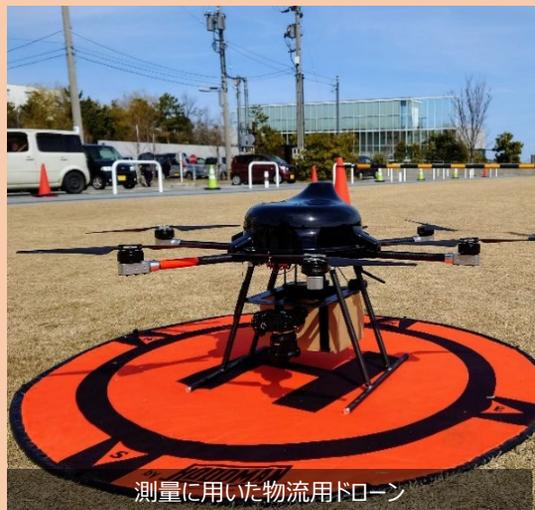
測量に用いた物流用ドローン
