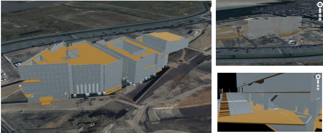
図 3D都市モデルへのBIM/CADの統合イメージ（PLATEAU VIEW上の羽田イノベーションシティ）
