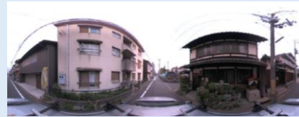
全方位画像からの壁面計測による 壁面属性の把握
