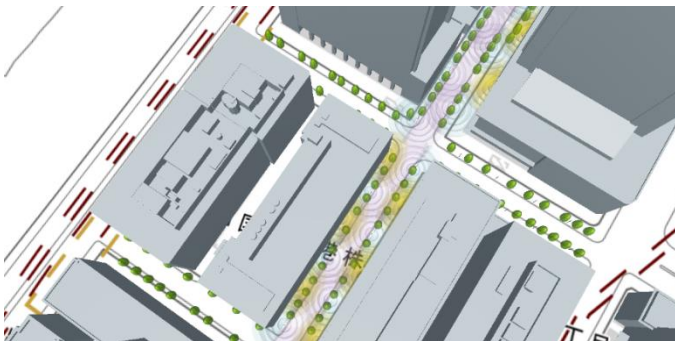
シミュレーションによる センサー配置パターンでの 計測範囲の確認
