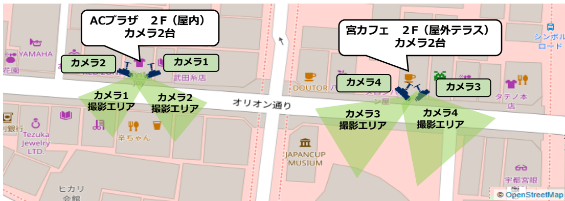
図 IPカメラ仮設場所および撮影エリア（※3）
