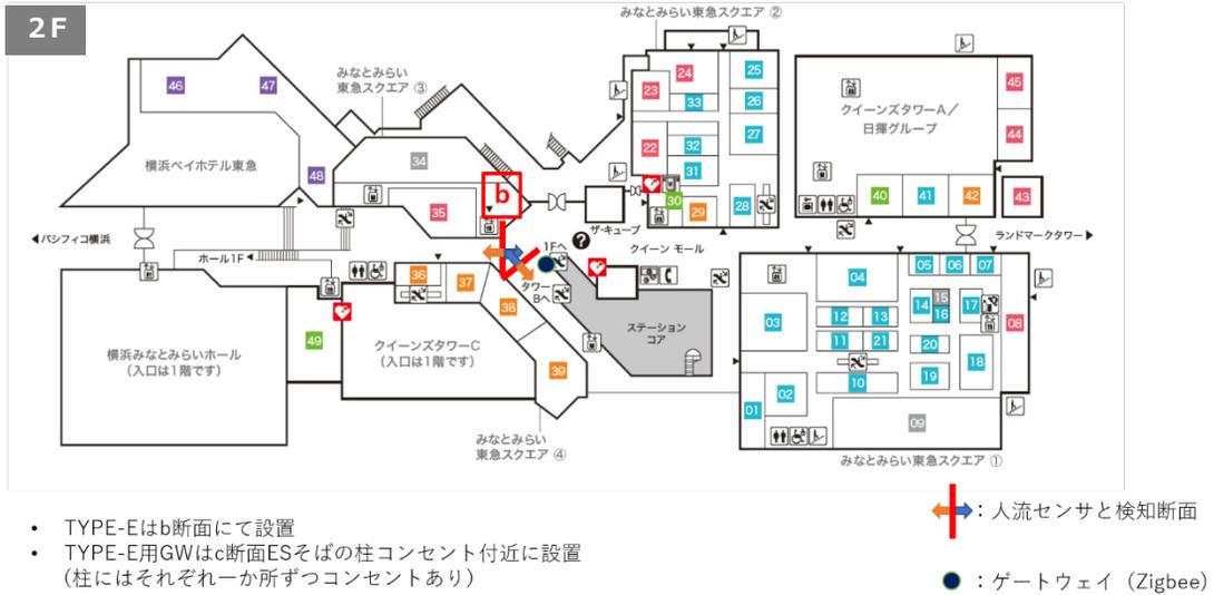
図 TYPE-Eセンサ設置箇所
