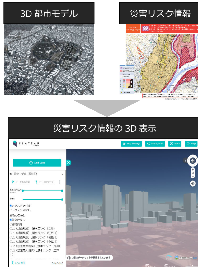
図 1-4 災害リスク情報の三次元化の仕組み
