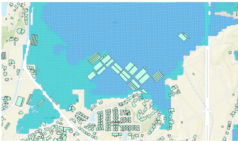
図 2-29 GIS ソフトウェア上での建物データと 3D 災害リスク情報の重畳
