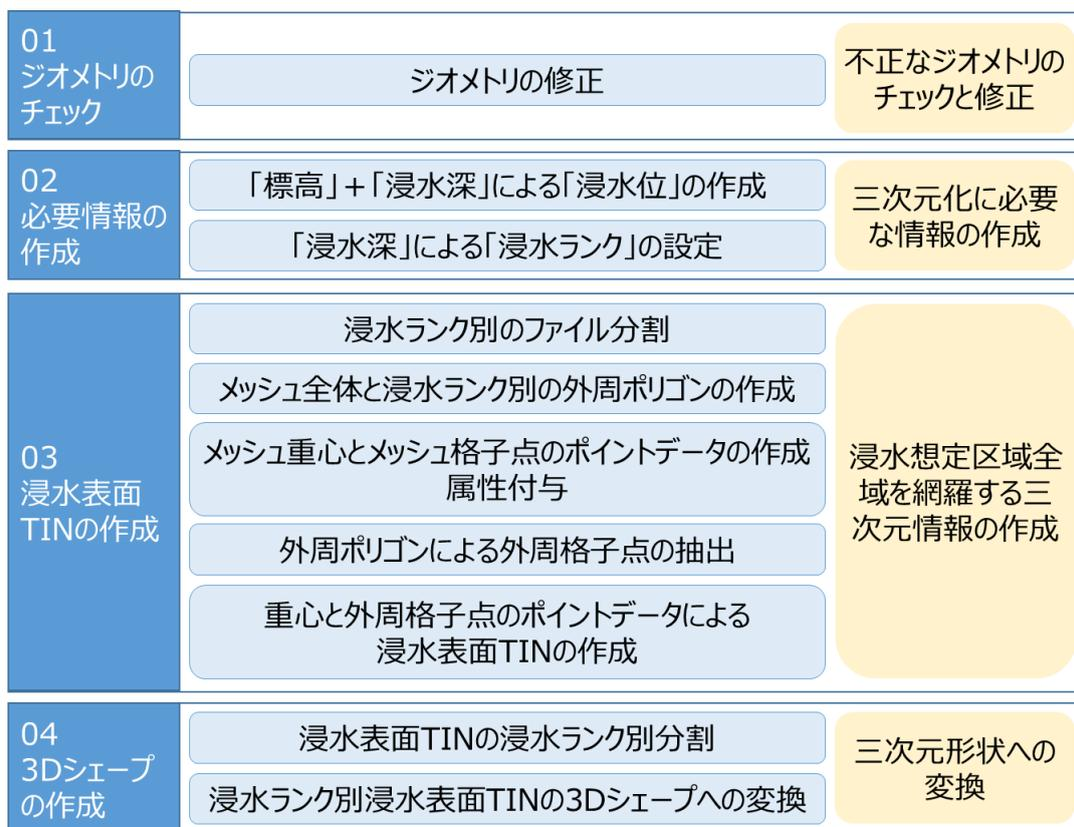
図 2-29 3D シェープの作成手順 (図 2-17 と同じ)
