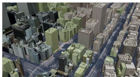
浸水ランクと屋根形状を表示した建築物モデル
