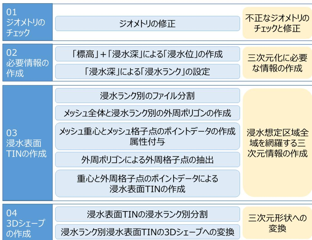
図 2-26 3D シェープの作成手順 (図 2-17 と同じ)
