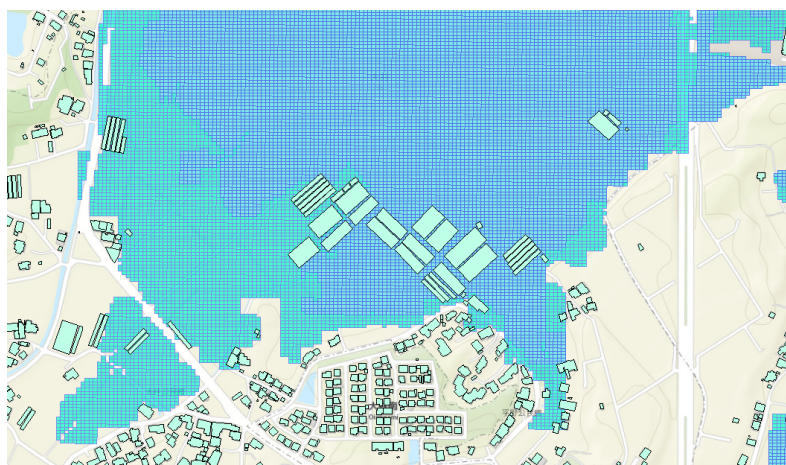
図 2-33 GIS ソフトウェア上での建築物データと 3D 災害リスク情報の重ね合わせ
