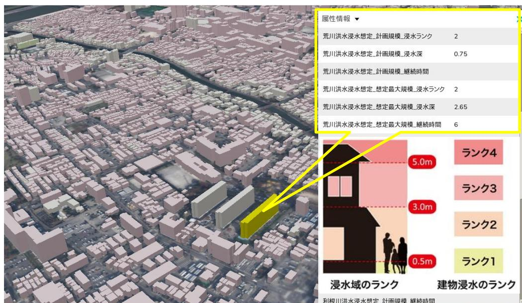
図 2-32 建築物への災害リスク情報の属性付与のイメージ
