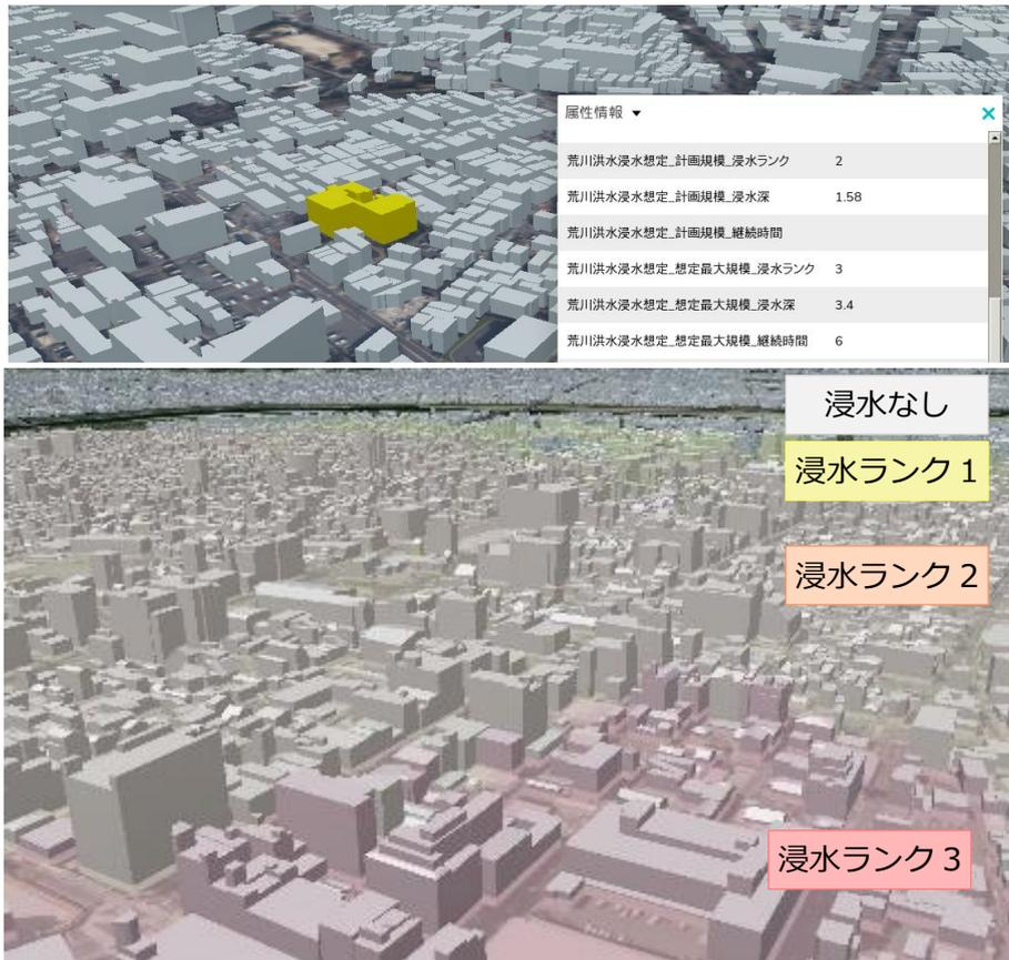
図 2-5 建築物モデルデータへの属性付与による三次元表示
