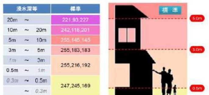
図 2-8 洪水浸水想定区域における浸水ランク
