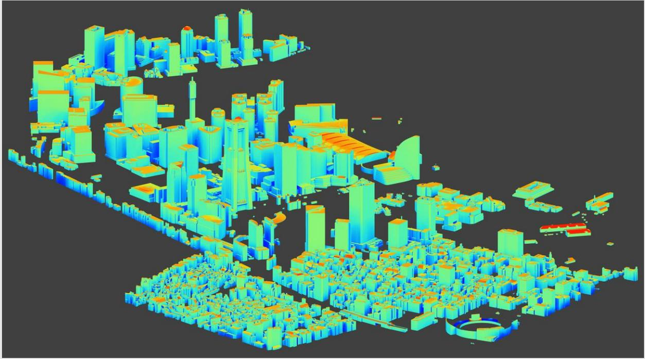
壁面太陽光発電パネルの発電量を推計するアルゴリズムを開発。
