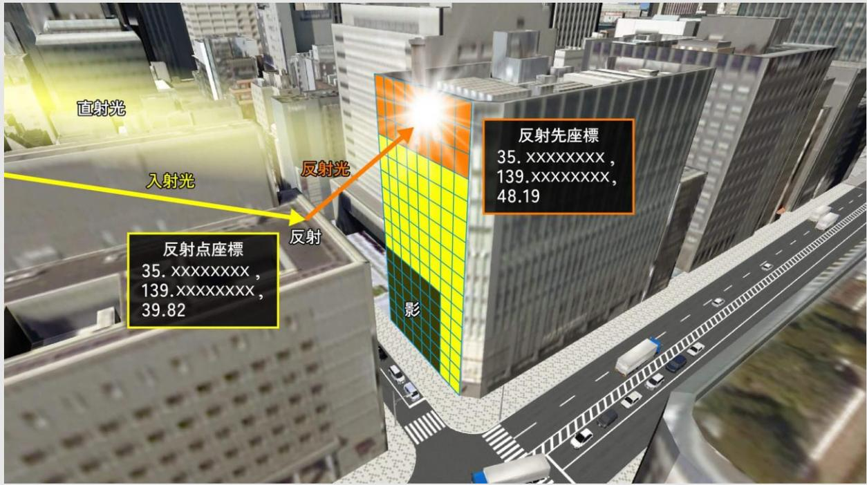
3D都市モデルを利用した建物外壁への日照シミュレータを開発。
