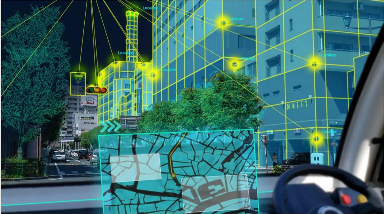
3D 都市モデルとカメラ画像等を組み合わせた VPS(Visual Positioning System)の実装に向け、
