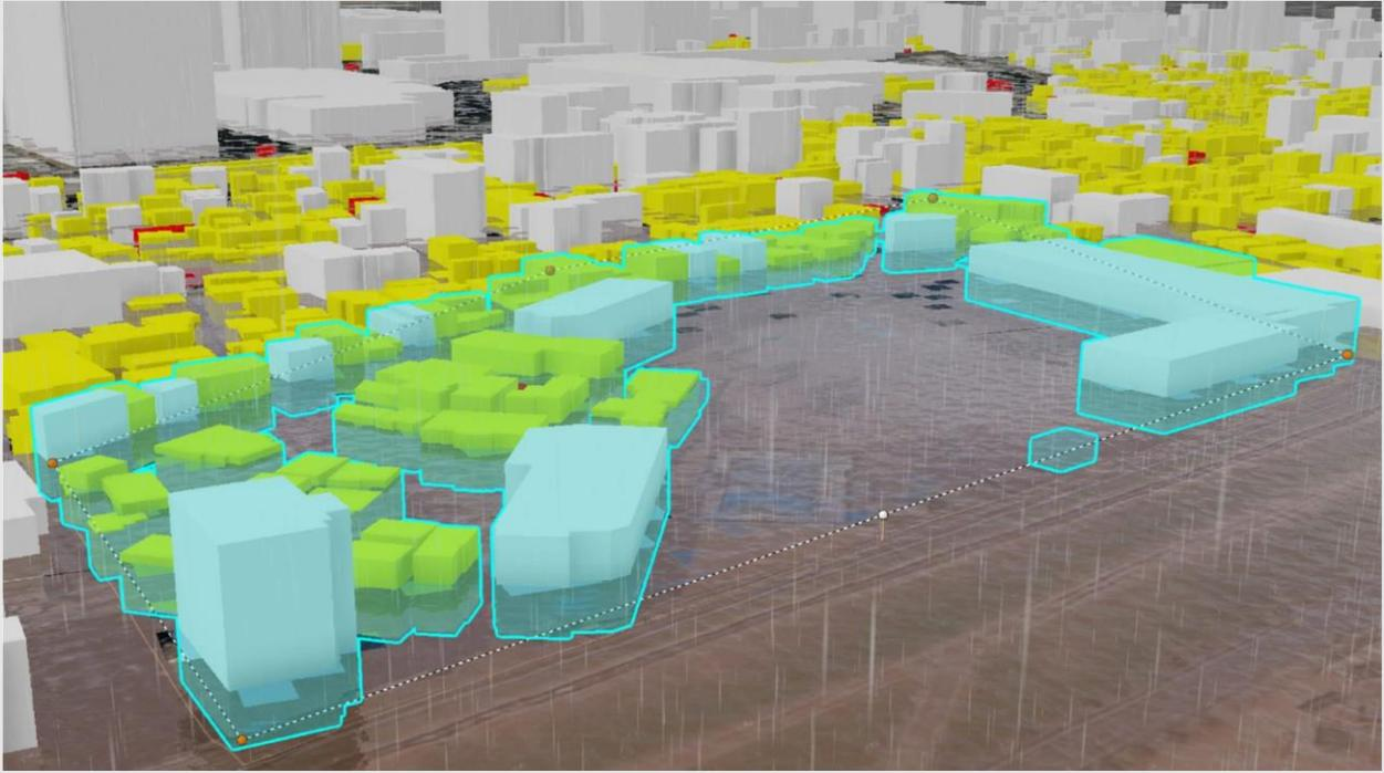
3D 都市モデルを活用し、水害・土砂災害による被害状況と想定被害額を算出するシステムを開発。
