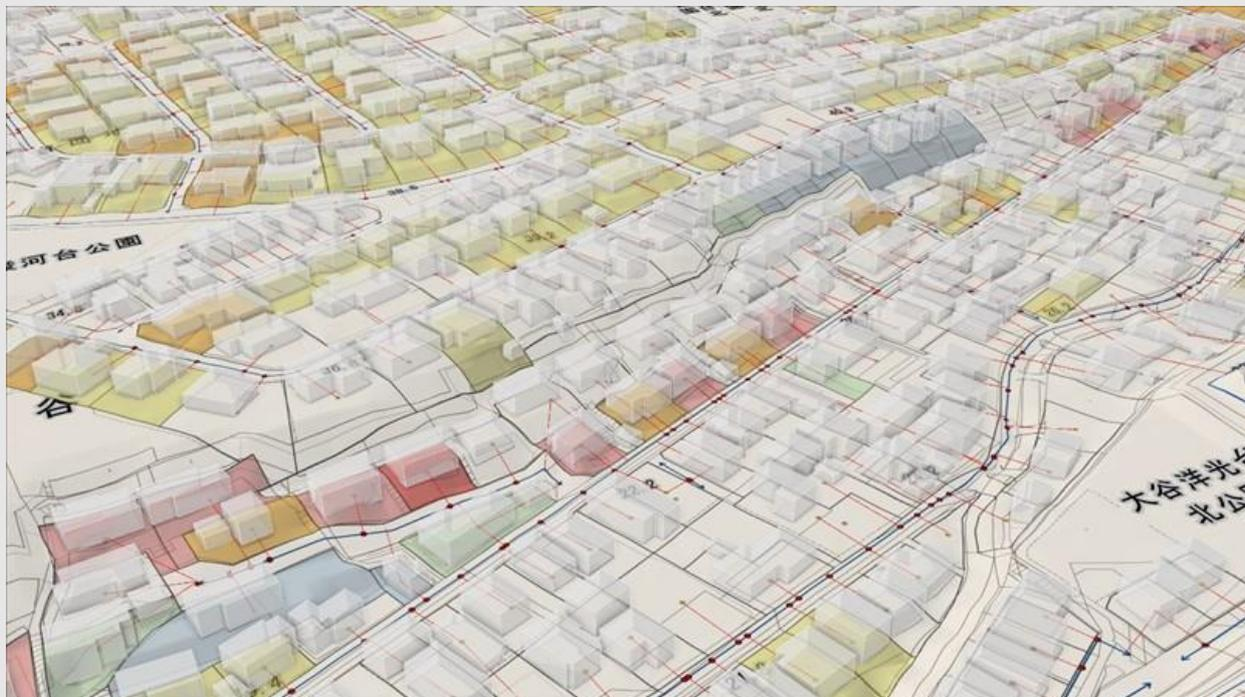
3D 都市モデルを活用し、宅地と道路の高低差や傾斜を GIS 上で正確に把握・計測する仕組みを構築し、不動産の査定や評価の効率化を実現。査定や評価に必要な地図やデータを重ねて表示・可視化し、関係者の円滑な合意形成を促進。
