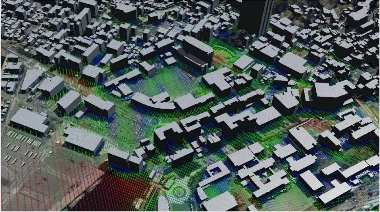
3D 都市モデルを活用した熱流体シミュレーションの実行と可視化をウェブで完結するシステムを開発。
