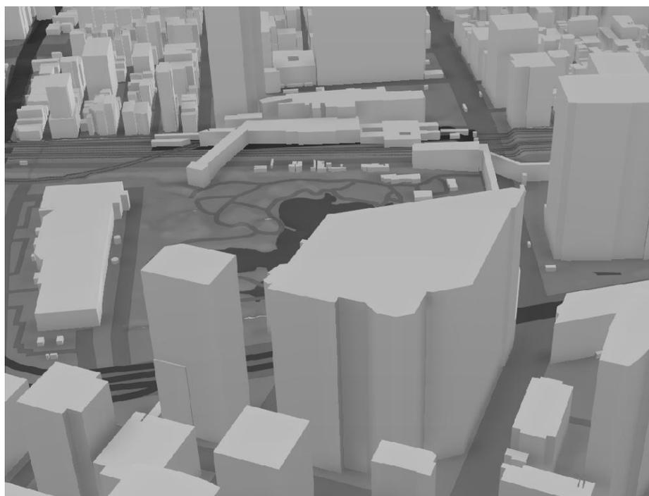
※LOD1 建物高さは測量された建物の高さの中央値を利用するため、実際の建物の高さとは異なるケースが存在する。特に、低層部と高層部を持つ建物では誤差が生じやすいため、高さの正確性が求められる場合には属性値の計測高さを利用することを推奨する。
