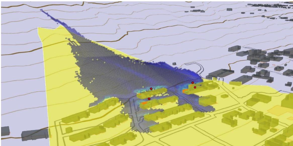
図 II-4-41. UC24-15 太陽光発電のポテンシャル推計及び反射シミュレーション v3.0
