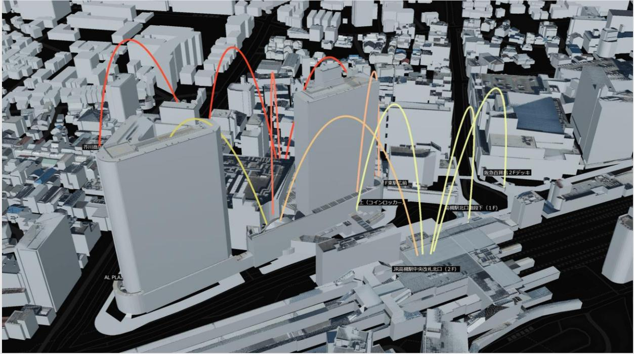
低コストかつ設置が容易な Wi-Fi パケットセンサーを用いた人流データの可視化を検証。
