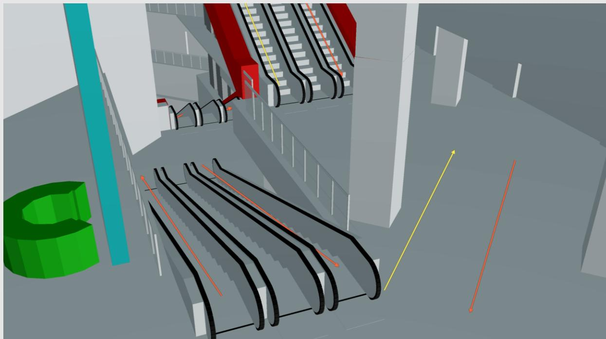
赤外線センサーによる人流解析技術を用いて屋内の混雑状況を 3D 都市モデルで可視化する技術を検証。
